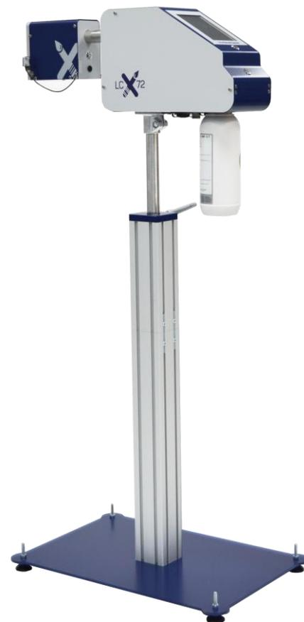
**APLINK LCX** est une nouvelle génération d'imprimantes à jet d'encre haute résolution, spécialement conçue et développée pour le codage des surfaces poreuses des emballages secondaires
